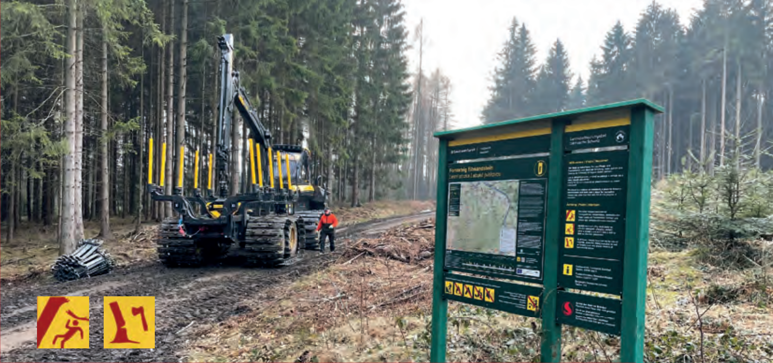
Info: Breite Ketten → wenig Bodendruck | široké pásy → nižší tlak na půdu | Wide chains → reduced soil pressure
